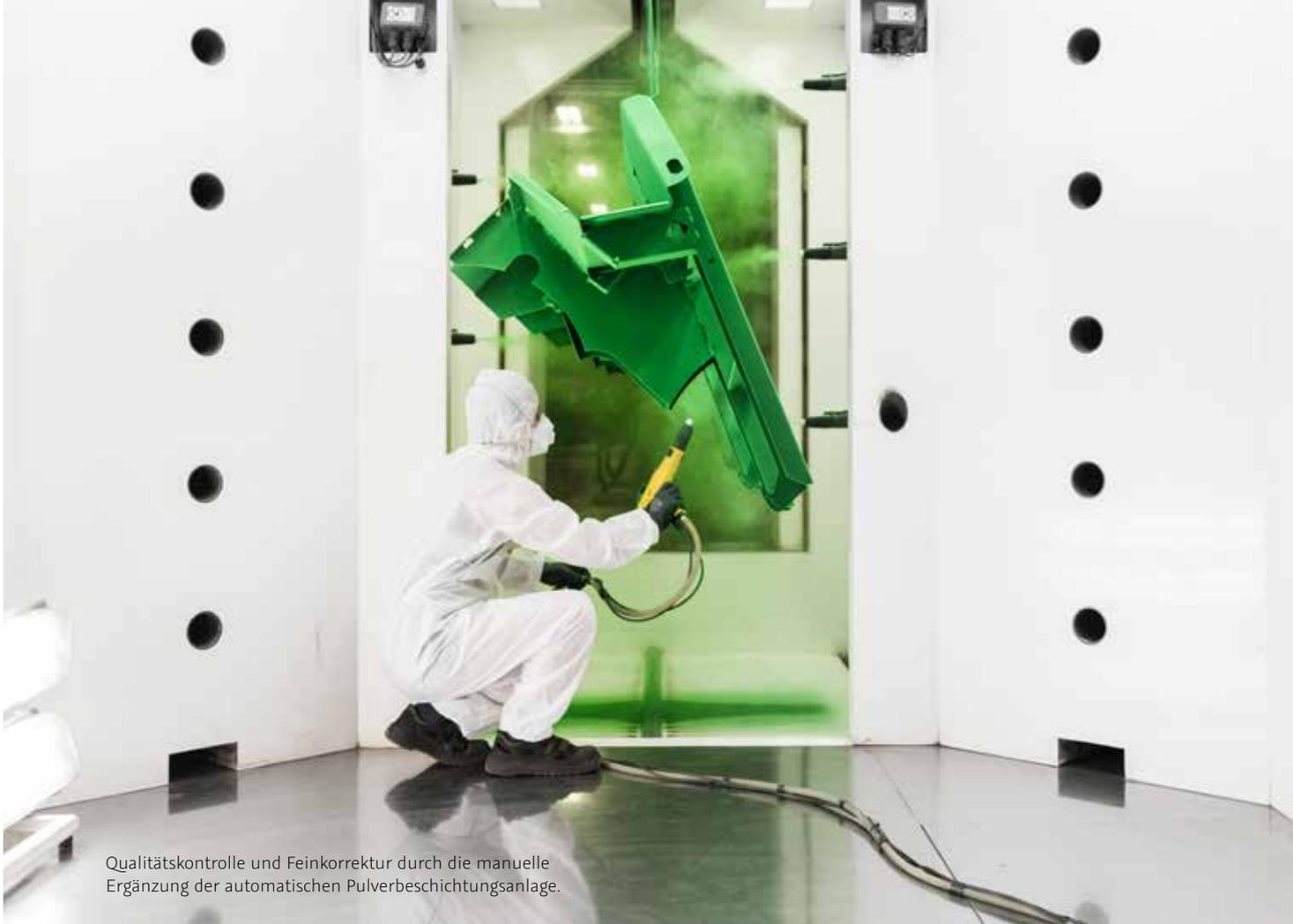
Qualitätskontrolle und Feinkorrektur durch die manuelle Ergänzung der automatischen Pulverbeschichtungsanlage.
