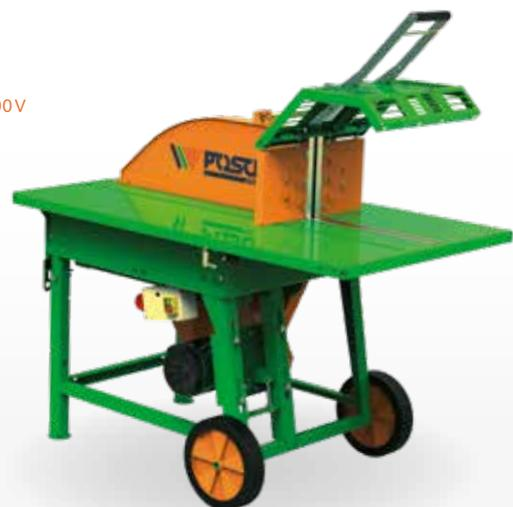
Rolltisch-Säge RE 5.5 Keilriemenantrieb
