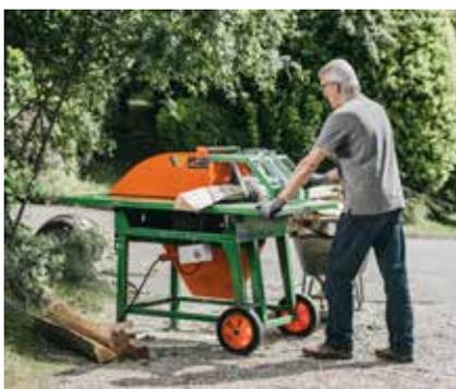
Leichtgängige, kugelgelagerte Tischführung für optimalen Bedienkomfort.
