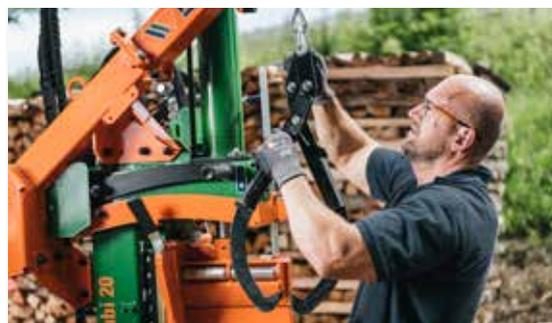
Die Seilwinde sowie die Greifzange inkl. Ablagemöglichkeit sind optional erhältlich.
