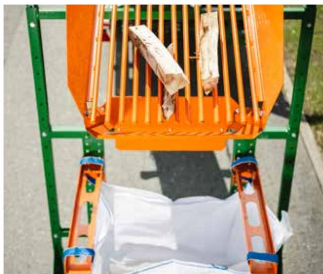
**Perfekt verwertet – bis zum Restholz.** Die gereinigten Scheite werden z. B. an ein weiteres Förderband übergeben oder direkt in einen Anhänger verladen. Die unerwünschten Teile wie Späne, Rinden- und Holzsplitter fallen direkt in den BigBag – perfekt für die Verwertung als z. B. Anzündholz.
