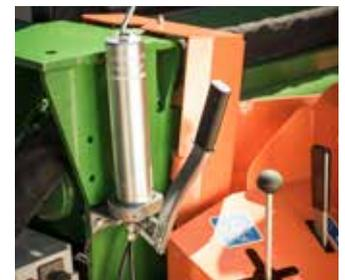
Integrierte Schmiervorrichtung über Handpumpe (optional erhältlich)
