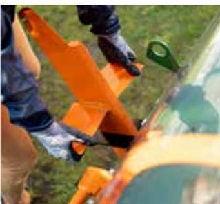
Das Spaltmesser kann in wenigen Sekunden werkzeuglos gewechselt werden.
