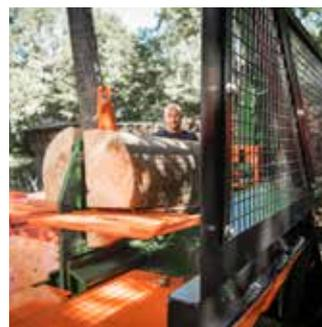
Das serienmäßige Sicherheitspaket (bestehend aus drei Gittern, Gitteraufnahme, verbreiterter Holzauflage sowie Sicherheitsventil) sorgt dafür, dass mehrere Personen ohne etwaige Risiken und Gefahren an der Maschine arbeiten können.
