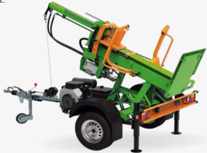
HydroCombi 20 Fahrwerk 20B15-R-PKW, Transportstellung
