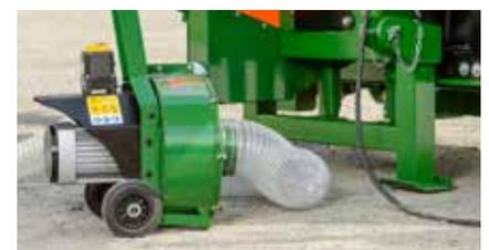
Späneabsauggebläse für Sägespalter.
