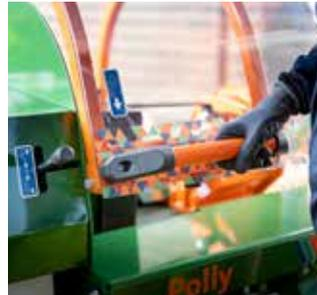
Klappe zu & Spaltvorgang marsch! Wenn Sie die Poly-Schutzverkleidung schließen, startet der Spaltvorgang automatisch – kein extra Handgriff, keine 2-Hand-Bedienung. Sie haben freien Blick auf den Spaltkanal und eine freie Hand für das nächste Holzsplit.
