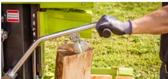
Mit der serienmäßigen Haltekrallen wird das Scheit sicher fixiert und das Arbeiten besonders einfach.
