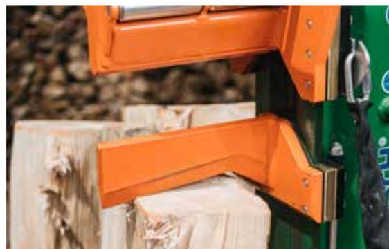
Mit dem patentierten zweiteiligen Spaltmesser (Fixomatic-System) kann das Holz ohne lästiges Festhalten beim Spaltvorgang fixiert werden.
