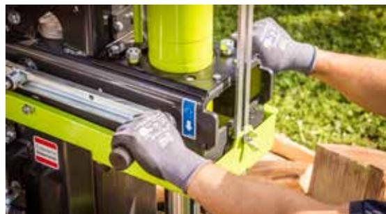
Die Zweihand-Schaltung gewährleistet ein sicheres Arbeiten, die Hände sind außerhalb des Gefahrenbereiches. Bei kürzeren Holzscheiten stellen Sie den Spalthub entsprechend ein: Dadurch verkürzt sich die Strecke des Spaltkeils, die er zurück legen muss und hilft Ihnen Zeit zu sparen.
