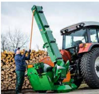
Für den Transport kann das Förderband leicht und schnell manuell eingeklappt werden. Die Neigung ist optional auch hydraulisch verstellbar.
