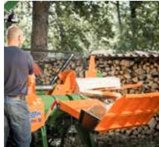
Der hydraulische Stammheber bringt schwere Stämme ganz leicht in Spaltposition. Die neue abgescräge Spaltwanne erleichtert das Nachspalten größerer Scheite und macht die Holzarbeit besonders effizient. Durch die ergonomische Bedienhöhe des Holzaufлагetisches können Sie anschließend bequem und kraftsparend weiterarbeiten.
