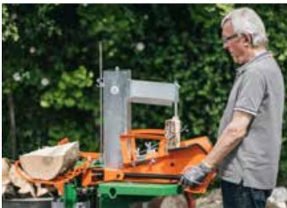
Durch die bequeme Fixiermöglichkeit des Holzes ist ein gefahrloses Spalten möglich.
