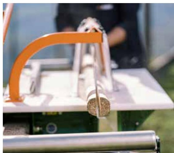
NEU: mit dem Kreissägenanbau teilen Sie Pfähle einfach in zwei Hälften.
