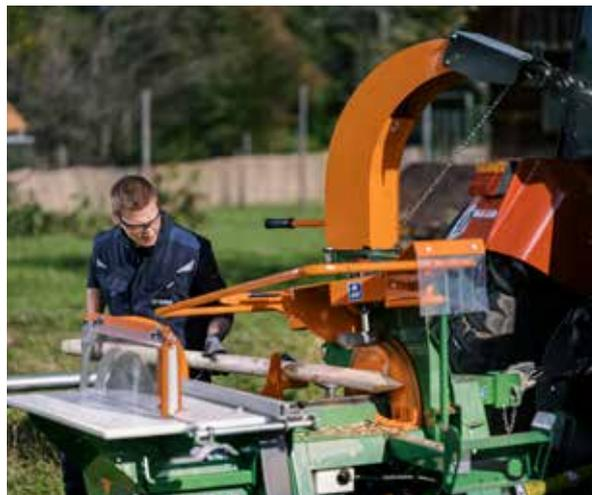
Mit dem eigentlichen SchälProfi entrinden und spitzen Sie Stämme. Mit dem Kreissägenanbau trennen Sie diese bei Bedarf in der Mitte durch.
