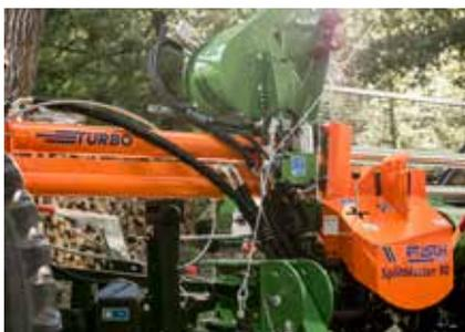
Das Doppel-Zylinder-Spaltsystem sorgt für einen doppelt so schnellen Rücklauf.
