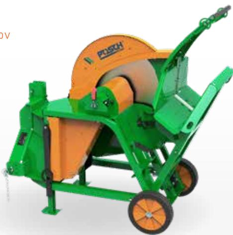
Wippsäge mit Zapfwellenantrieb
