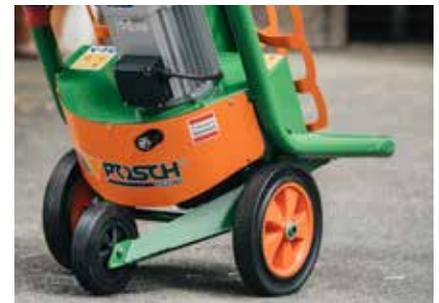
Die großen Vollgummiräder mit einem Durchmesser von 30 cm und das zusätzliche dritte Stützrad sorgen für einen komfortablen Hand-Transport.
