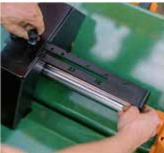
Stellen Sie den Spalthub auf die gewünschte Holzlänge ein – mit einem Handgriff und ganz ohne Werkzeug. Dadurch sparen Sie Zeit, da der Stempel nicht mehr vollständig zurückfährt.
