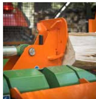
Das robuste Druckstück wird mit voller Kraft bis ans Spaltmesser gedrückt. So wird auch fasriges oder astreiches Holz mühelos zur Gänze durchgespalten. Die präzise Führung sorgt für eine lange Lebensdauer.
