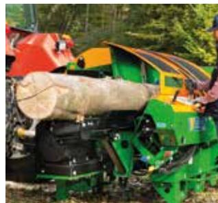
Über das Einzugsband wird der Stamm in Sägeposition gebracht. Der hydraulische Niederhalter und der automatisch lüftende Holzanschlag verhindern ein Klemmen des Holzstammes.
