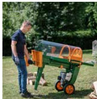
Oscar kann einfach über das Handfahrwerk zum Einsatzort bewegt werden.
