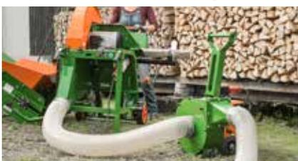
Über einen 2-m Saugschlauch ( $\varnothing$  15 cm) und einen 10-m-Druckschlauch ( $\varnothing$  12 cm) werden die anfallenden Späne abgesaugt.
