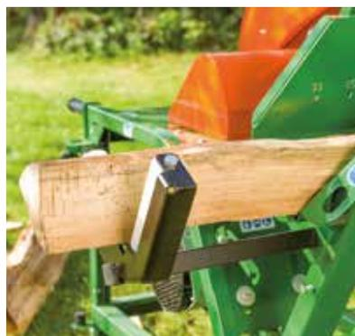
Die Wippverlängerung (F0003779) sorgt dafür, dass auch lange Holzscheite sicher gehalten werden. Über Rollen lässt sich das Scheit leichtgängig zum nächsten Schnitt bewegen.
