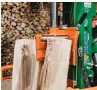
Die gleitgelagerten Rollen verhindern ein Verklemmen des Weichholzes im Retourlauf und sorgen für ein unterbrechungsfreies Arbeiten. Der hochwertige Werkzeugstahl und die präzise Verarbeitung sind die Garantie für eine besonders lange Lebensdauer des Spaltmessers.
