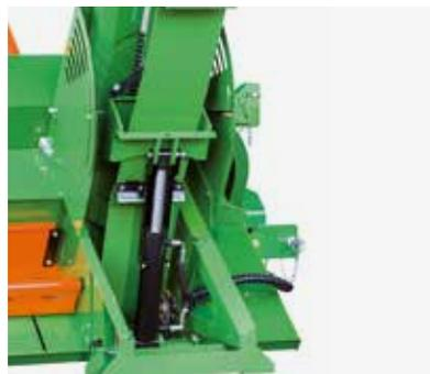
Komfortable hydraulische Verstellung der Auswurfhöhe beim Teleskop-Förderband.
